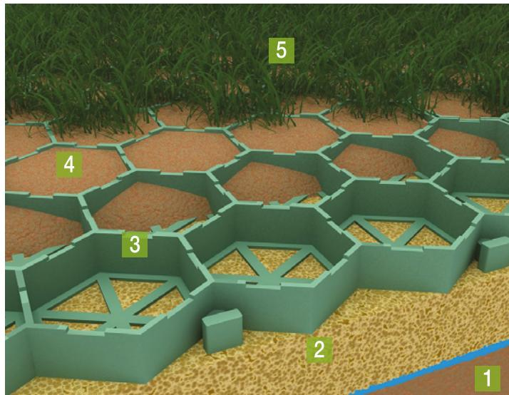
Конструктивная схема пешеходной зоны с зеленым покровом при использовании решетки «Ecoteck Green»
