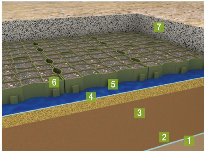
Конструктивная схема конно-спортивного поля с использованием решетки «Ecoteck Maneg»
