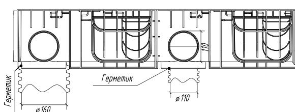
рис. 1. Схема подключения канализационных труб к водоотводному лотку
