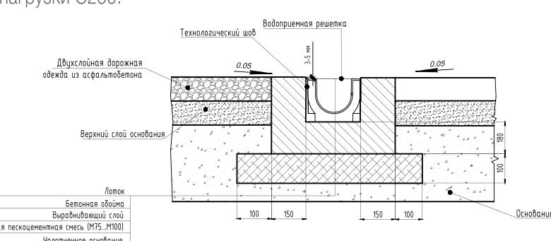
Лоток ECOTECK HEAVY 100.125h125 устанавливается на бетонное основание с толщиной мин. 180мм. Боковой выступ должен составлять мин. 150 мм.
