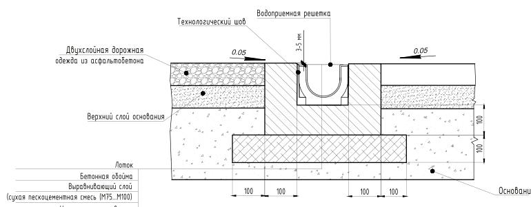
Лоток ECOTECK Standart 100.125h129 устанавливается на бетонное основание с толщиной мин. 100мм. Боковой выступ должен составлять мин. 100 мм.
