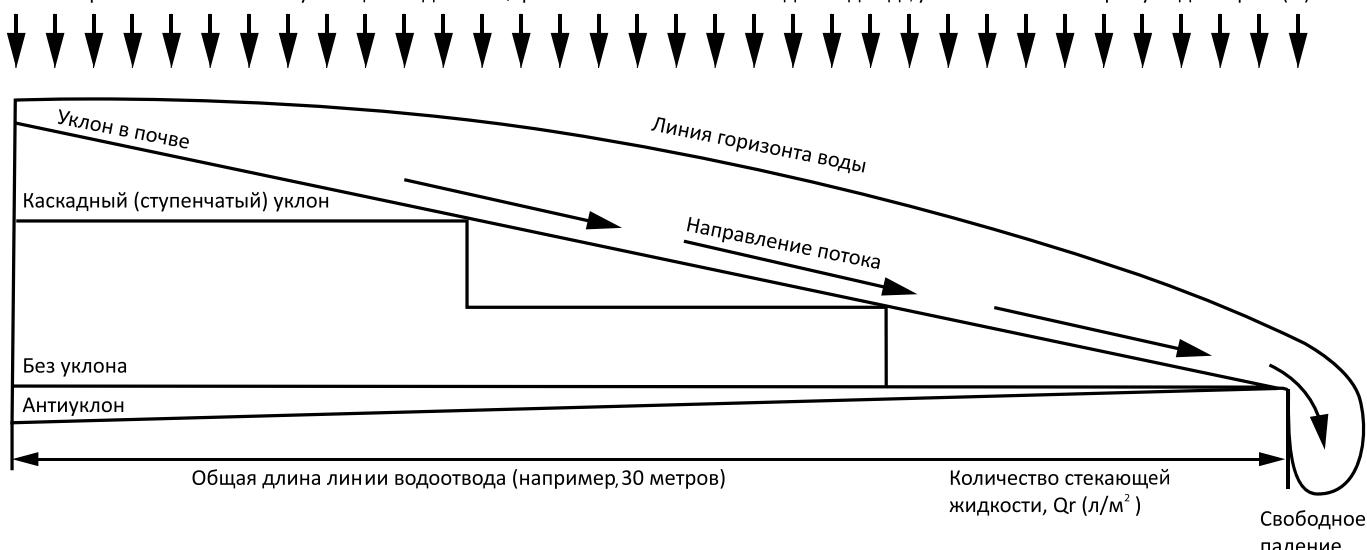
Формирование дна водоотводного лотка с или без уклона не влияет на количество стекающей жидкости. Линия горизонта воды всегда выстраивается одинаково. А количество стекающей жидкости определяется только поперечным сечением водоотводного лотка, уклон не имеет значения.
