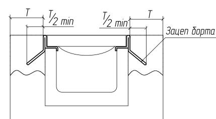
рис. 2. Укладка лотка в бетонную обойму.
