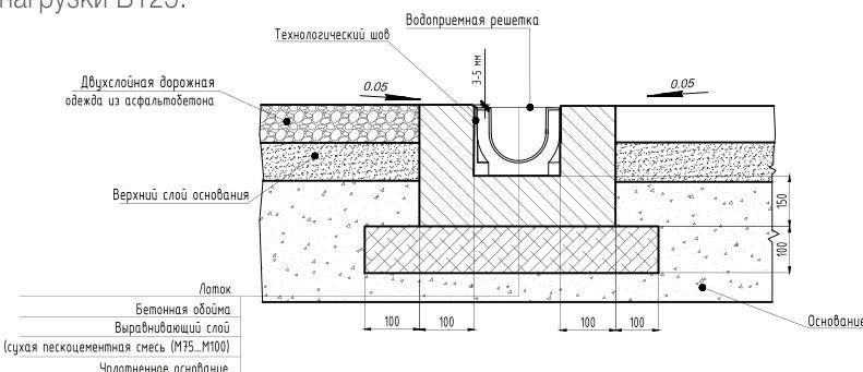
Лоток ECOTECK Standart 100.125h129 устанавливается на бетонное основание с толщиной мин. 150мм. Боковой выступ должен составлять мин. 100 мм.
