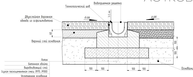
Лоток ECOTECK Standart 100.125h129 устанавливается на бетонное основание с толщиной мин. 100мм. Боковой выступ должен составлять мин. 100 мм.
