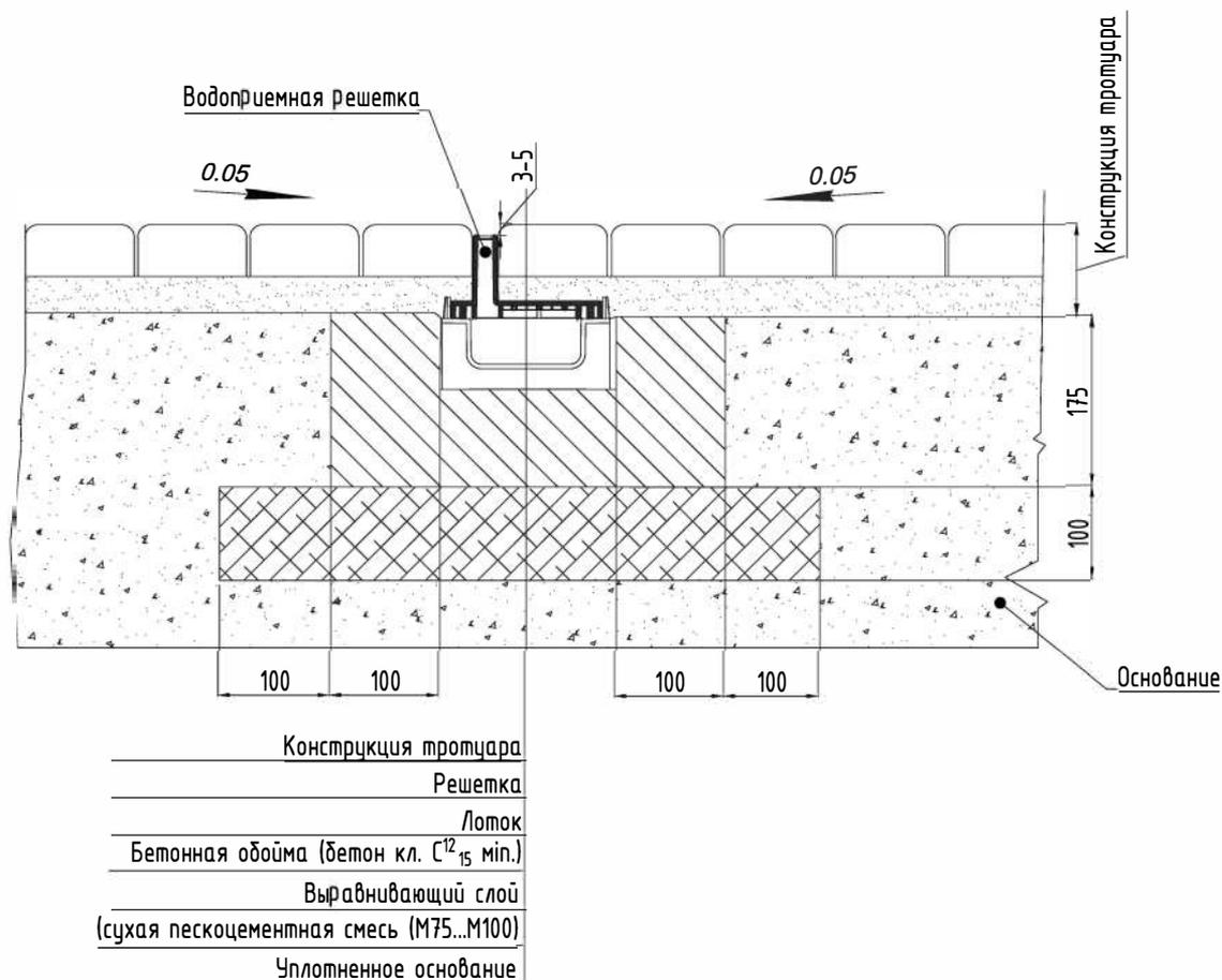
Лоток ECOTECK LITE 100 h72 устанавливается на бетонное основание с толщиной минимум 100 мм. Боковой выступ должен составлять минимум 100 мм.
