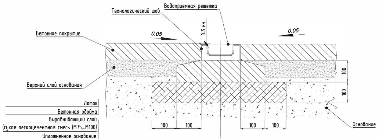
Схема монтажа водоотводного лотка Ecotек LITE 100 h56 в поверхность, мощеную штучным камнем и асфальтобетонным покрытием. Класс нагрузки А15.
