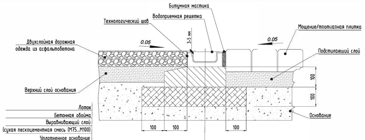
Лоток ECOTECK LITE 100 h56 устанавливается на бетонное основание с толщиной минимум 100 мм. Боковой выступ должен составлять минимум 100 мм.
