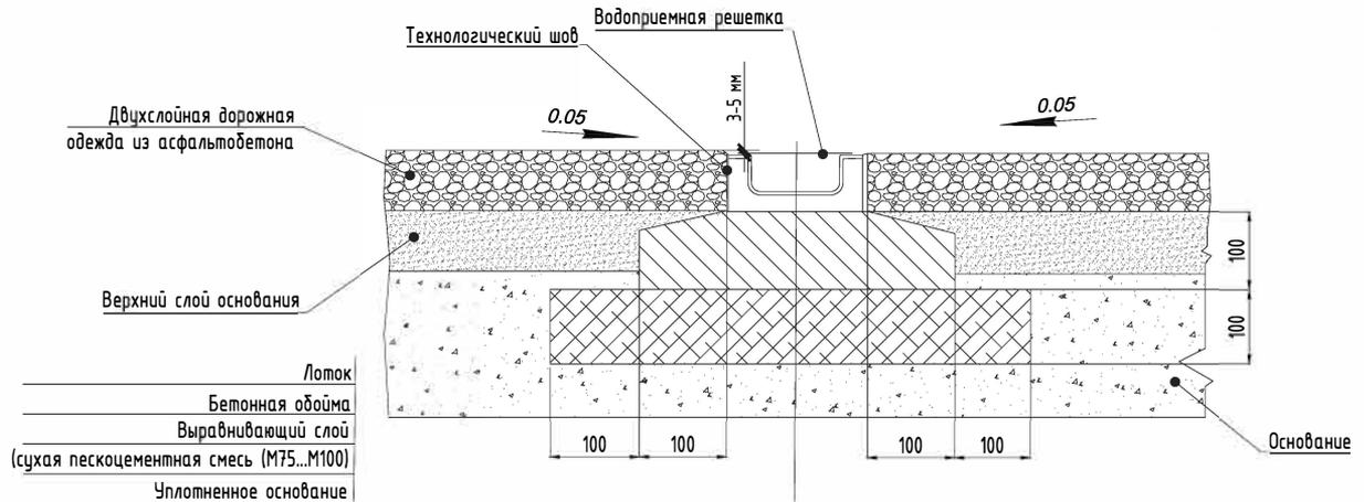
Схема монтажа водоотводного лотка Ecotек LITE 100 h56 в поверхность из бетонного покрытия. Класс нагрузки А15.
