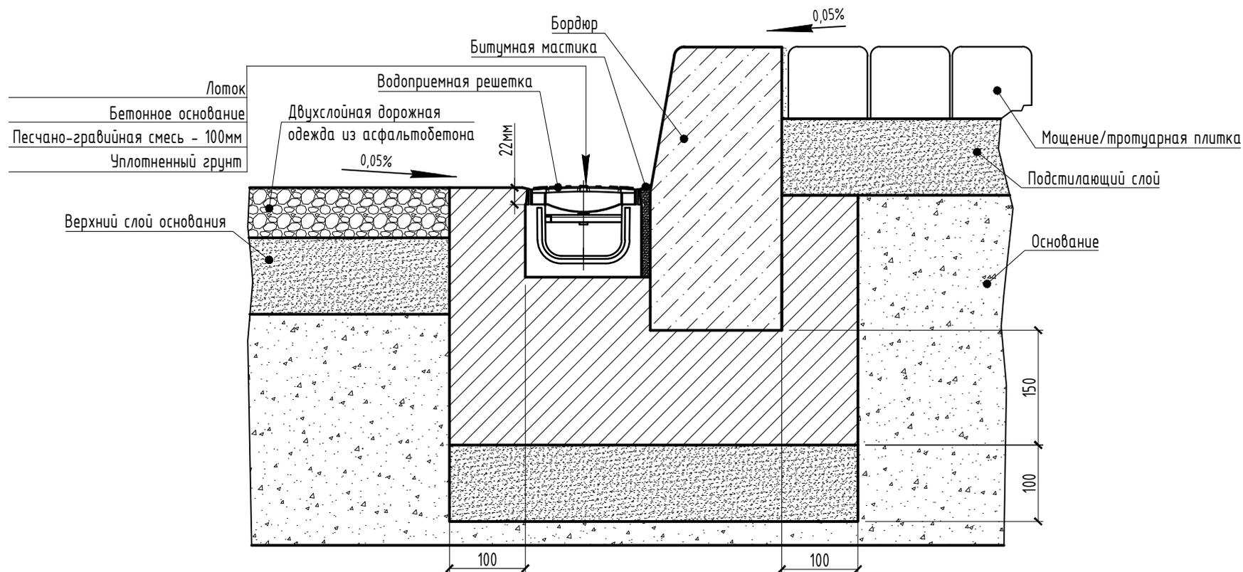
Лоток ECOTECK Medium 100.95h115 устанавливается на бетонное основание с толщиной мин. 150мм от низа. Боковой выступ должен составлять мин. 100мм от края.
