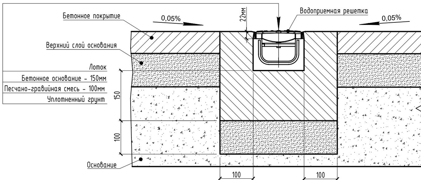
Лоток ECOTECK Medium 100.95h115 устанавливается на бетонное основание с толщиной мин. 150мм. Боковой выступ должен составлять мин. 100мм.
