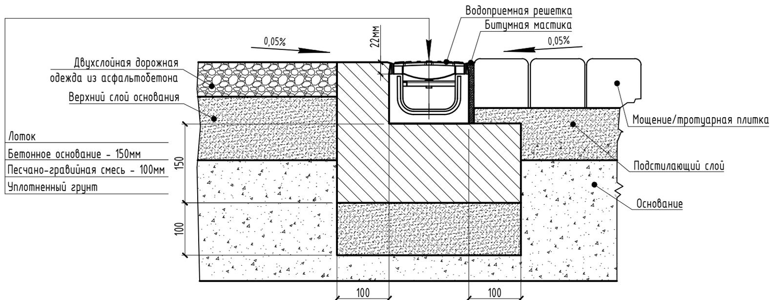
Лоток ECOTECK Medium 100.95h115 устанавливается на бетонное основание с толщиной мин. 150мм. Боковой выступ должен составлять мин. 100мм.
